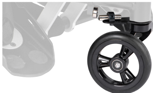
Kompensaatio-mekanismi yhdellä kädellä ajamista varten
