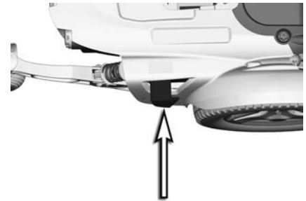
Kuva 92. Vapautettujen jarrujen kytkeminen päälle
