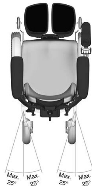
Kuva 97. Kuormahihnojen kulma ei saa ylittää 25°.
