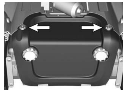
Kuva 103. Rungon etummainen kotelo on kiinni kahdella kahvalla.
