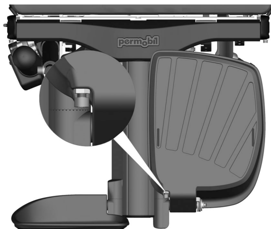
Kuva 19. Jalkalevyjen kulmaa voi säätää ruuvilla ja vastamutterilla.
