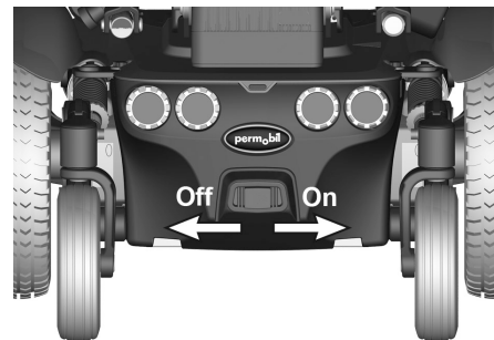
Kuva 120. Pääsulakkeen/akun virrankatkaisimen palautus.
