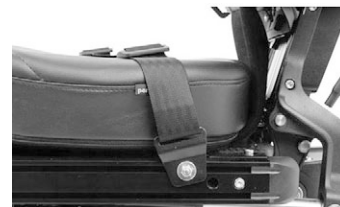
Kuva 19. Asennettu vyö, vasen puoli.
