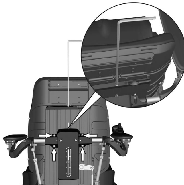
Kuva 24. Käsituen korkeuden säätäminen
