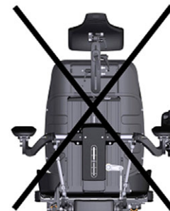
Kuva 110. Mitään istuimen kohtaa EI saa käyttää pyörätuolin kiinnittämiseen paikalleen.
