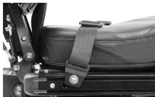
Kuva 17. Asennettu vyö, oikea puoli.
