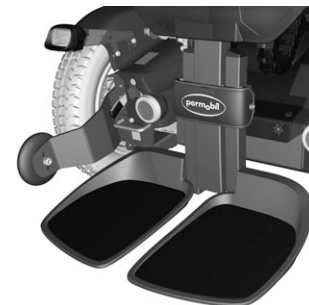
Kuva 20. Jalkatuen kotelo on kiinnitetty kahdella ruuvilla.
