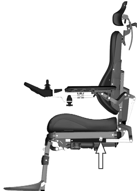
Kuva 16. Selkänojan kallistuksen käsin säädettävä lukitusputki
