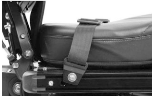
Kuva 19. Asennettu vyö, oikea puoli.
