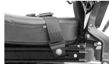
Kuva 21. Asennettu vyö, vasen puoli.
