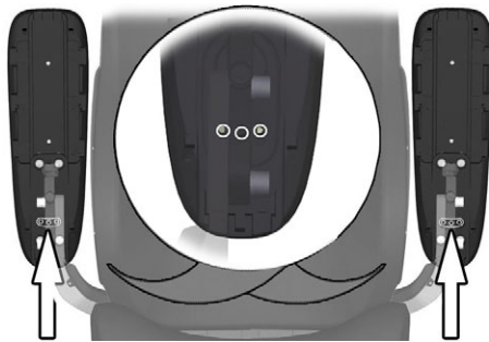
Kuva 21. Ääriasennot asetetaan siirtämällä yhtä tai kahta ruuvia kolmessa eri kohdassa käsinojan alapuolella.
