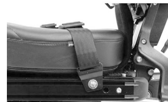
Kuva 17. Asennettu vyö, vasen puoli.
