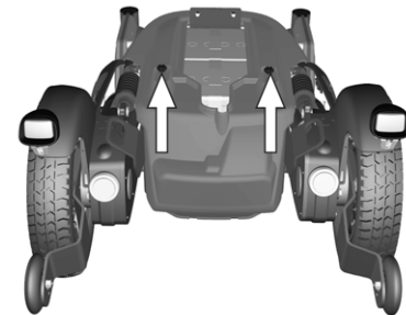
Kuva 117. Suojus on kiinni kahdella kahvalla.
