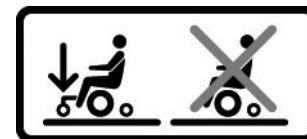
Kuva 130. Tukipyörät on aina oltava asennettuina ajon aikana.
