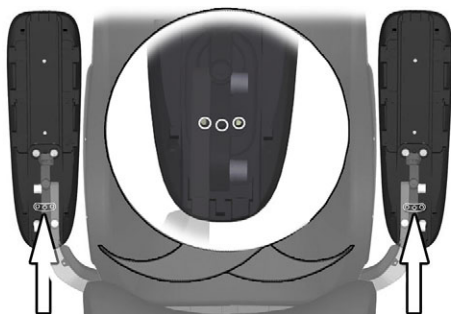
Kuva 27. Ääriasennot asetetaan siirtämällä yhtä tai kahta ruuvia kolmessa eri kohdassa käsinojan alapuolella.
