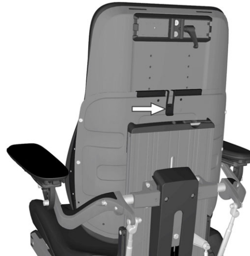
Kuva 110. Selkänojan yläosa on kiinnitetty lukitusmekanismilla.
