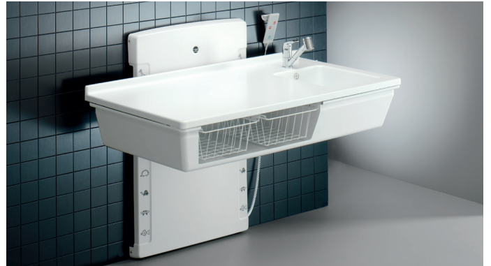
R8682000 Alhaisella aloituskorkeudella (low start) varustettu hoitopöytä. Seinäkiinnitteinen. Sisältää kiinteän altaan sekä pesuhanan. Korkeussäätö 300-1000mm.
