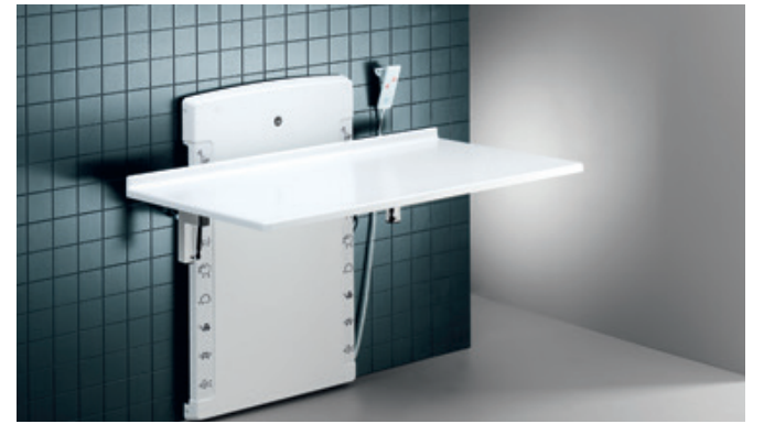
R8672000 Alhaisella aloituskorkeudella (low start) varustettu hoitopöytä. Seinäkiinnitteinen. Hoitotaso voidaan kääntää alas tilan säästämiseksi. Korkeussäätö 300-1000mm.
