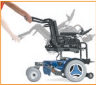
Lisävarusteena kahva manuaalista kallistusta varten, korkeuden säätö helposti ilman työkaluja.
