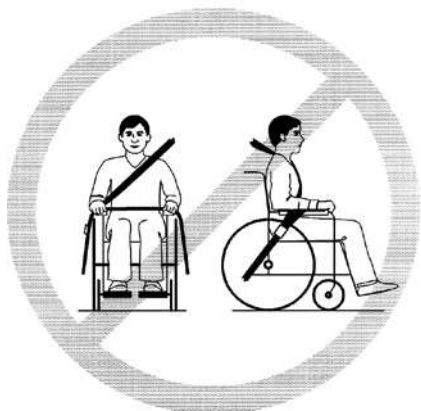
Kuvassa 4: Pyörätuolin osien kuten käsinojien tai pyörien ei saa estää vyötä tukemasta kehoa. Pelkän lantiovyön käyttäminen EI riitä.
