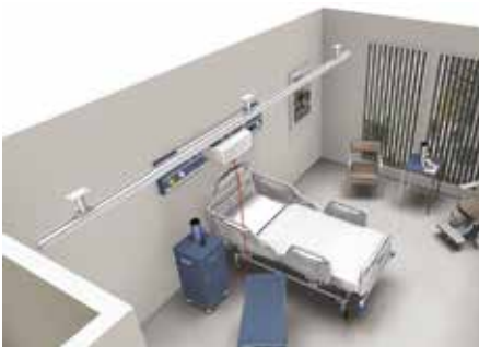
Kahden paikan välinen nosto kiinteää kiskoa pitkin (suorakiskoinen järjestelmä).
