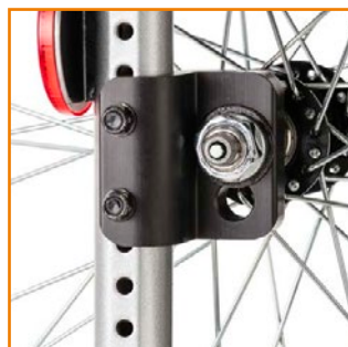
Kelauspyörän kiinnityspaikkaa muuttamalla voi lisätä vakautta.
