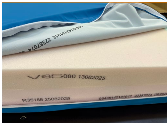
Laadunvalvonta on huolellista. Patjan pehmuste ja päällinen merkitään valmistuserän ja -ajan mukaisesti
