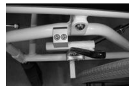
Kuva 12: Varmista, että jarrut ovat tiukasti kosketuksissa renkaaseen.
